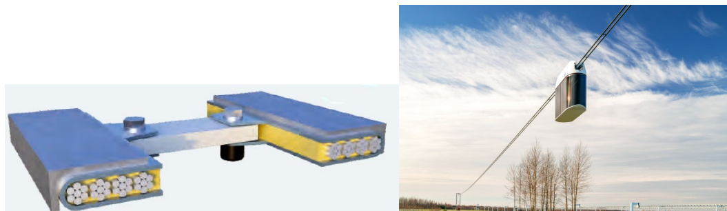
Рисунок 5 — Гибкая путевая структура (конструктивные элементы, вариант рельса), ЭкоТехноПарк, Марьино Горка, 2018 г.
