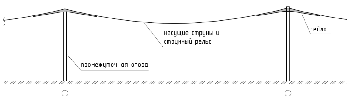
Рисунок 4 — Конструктивная схема гибкой путевой структуры
