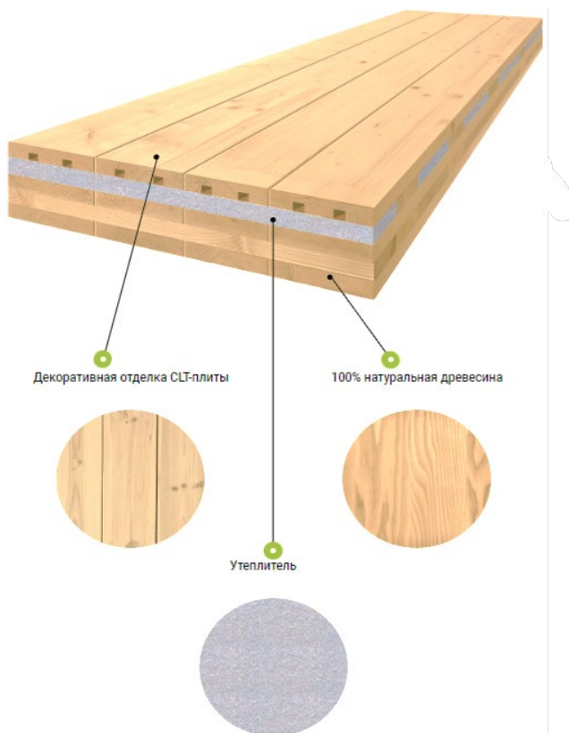
Рис. 2. Состав плит GrO Thermo .
